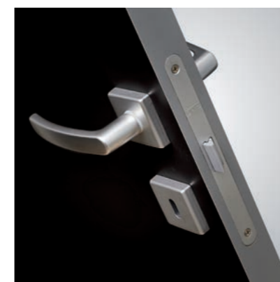
Serratura meccanica centromediana, finitura in cromo satinato con scrocco in teflon
