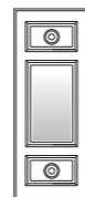
Finestrata vetro centrale con vetro ad infilare Glazed central glass with slide-in glass
